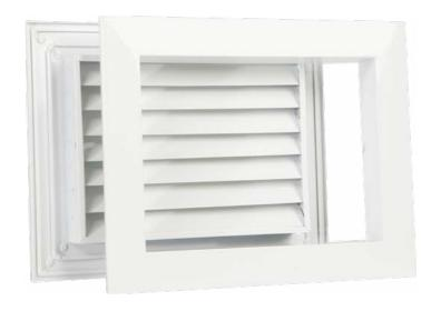
Описание. Переточная решетка OV служит для перераспределения воздуха между помещениями. За счет особой формы жалюзи предотвращает возможность просмотра между помещениями. Выполняет защитные и декоративные функции. Решетка может быть установлена в дверь или проем толщиной от 26 до 50 мм.
