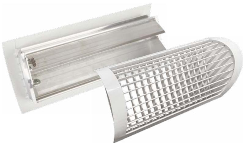
**Описание.** Двухрядная регулируемая цилиндрическая вентиляционная решетка DRGC-R используется в системах приточно-вытяжной вентиляции и кондиционирования. Имеет цилиндрическую форму и предназначена для установки в воздуховоды круглого сечения. Два ряда горизонтальных и вертикальных жалюзи подвижны и могут распределять потоки воздуха вверх/вниз и вправо/влево. Управление жалюзи осуществляется вручную, после выбора положения жалюзи остаются жестко зафиксированными за счет специ-
