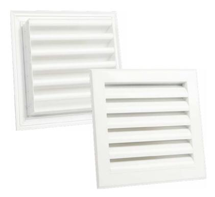
Описание. Усиленная наружная решетка OGD устанавливается на фасад здания, служит для забора и удаления воздуха в системах вентиляции. Изделие возможно использовать также в защитных и декоративных целях. Специально разработанные полые S-образные жалюзи предоставляют дополнительную защиту при сильном ветре и косом дожде. Изделие имеет повышенные антивандальные качества.
